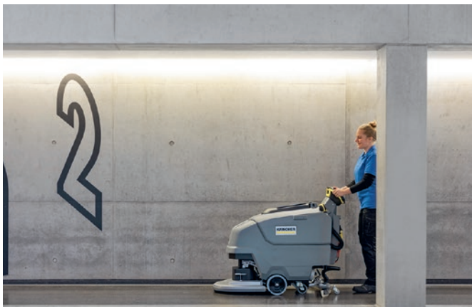
Mit einem Anpressdruck von 27 kg ermöglicht die neue Scheuersaugmaschine eine gründliche Flächenreinigung (Bild: Kärcher).
